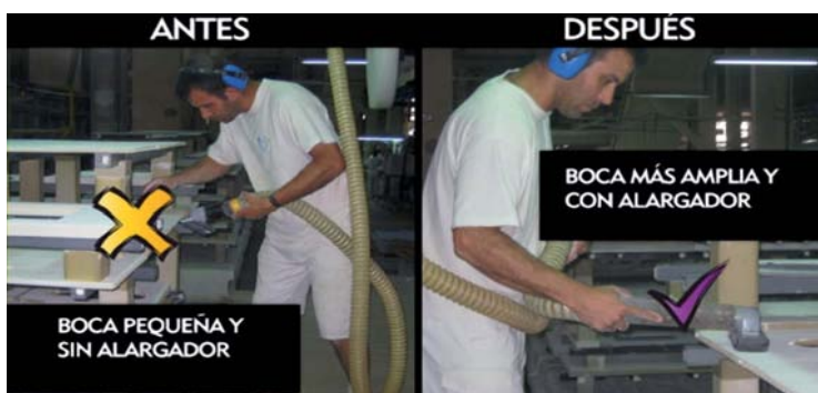
Figura 3 ■ Cambio en una herramienta de trabajo para mejorar la postura y reducir la repetición de movimientos. Empresa de elaboración de productos cerámicos
