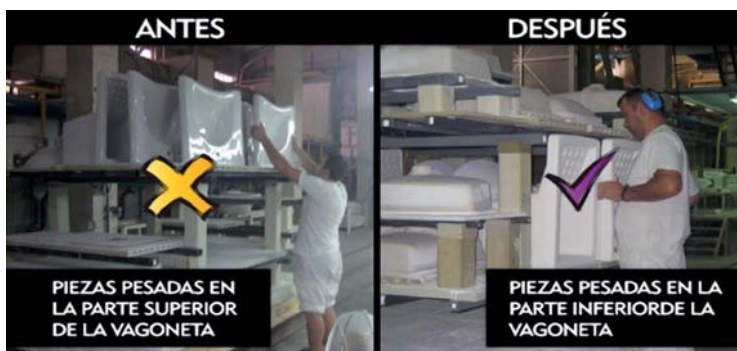
Figura 2 ■ Cambio en el equipo y método de trabajo para eliminar la manipulación de cargas con los brazos por encima de los hombros. Empresa de elaboración de productos cerámicos
